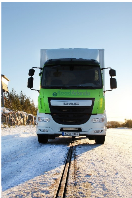
Figur 3.8 Elways nedsänkta skena med lastbil
