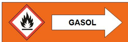
Exempel på märkning av en rörledning med gasol
